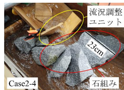
Fig. 1 流況調整ユニット および石組みの設置例 Example of installation of the flow adjuster and arranged stones
